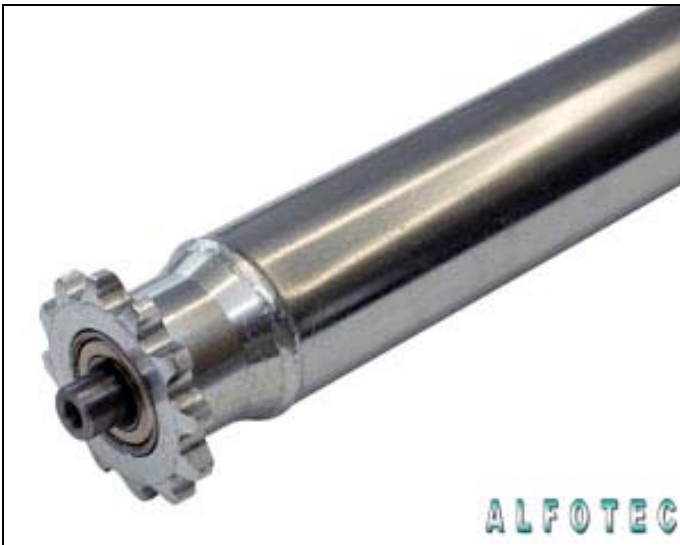
Tragrolle mit Stahlrohr, Präzisionskugellager und Einfachkettenrad Serie RT2 EKR, 1/2x5/16" oder 5/8x3/8" mit 13 oder 15 Zähnen, andere auf Anfrage
